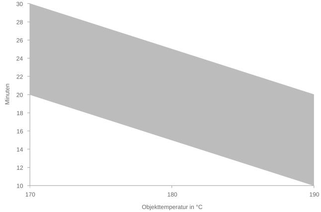
T Objekt t min t max 170 °C 20 Minuten 30 Minuten 180 °C 15 Minuten 25 Minuten 190 °C 10 Minuten 20 Minuten
