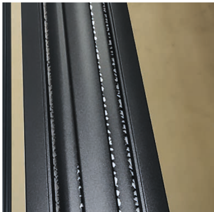
Popękana powierzchnia po utwardzeniu
