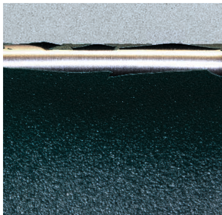
Łuszczenie się warstwy powłoki
