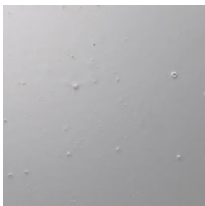
Oberflächenstörung durch Ausgasung
